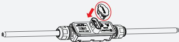
Hinweis: Wenn Sie das AC-Kabel des Wechselrichters vom 3P-AC-Bus-Steckverbinder entfernen müssen, verwenden Sie das Entsperrwerkzeug für den 3P-AC-Steckverbinder und führen Sie das Werkzeug in die Seite des AC-Steckverbinder ein, um es zu entfernen.
