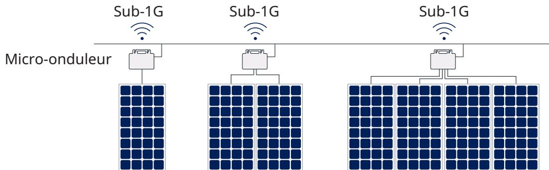
Ce manuel s'applique au micro-onduleur 4-en-1 de Hoymiles. Dotés d'une puissance de sortie de 2 000 VA, les micro-onduleurs de la nouvelle gamme HMS-2000 de Hoymiles sont classés parmi les plus puissants micro-onduleurs 4-en-1.
