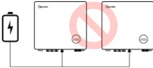
Une même batterie ne peut pas être connectée à plusieurs onduleurs.
