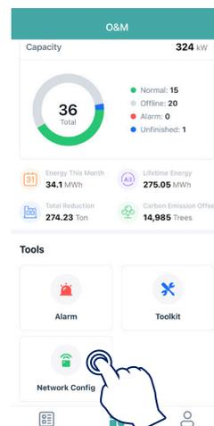
(b) Seleccione la red inalámbrica del DTS y haga clic en conectar. (El nombre de la red del DTS consta de DTS y el número de serie del producto y la contraseña predeterminada es ESS12345.)
