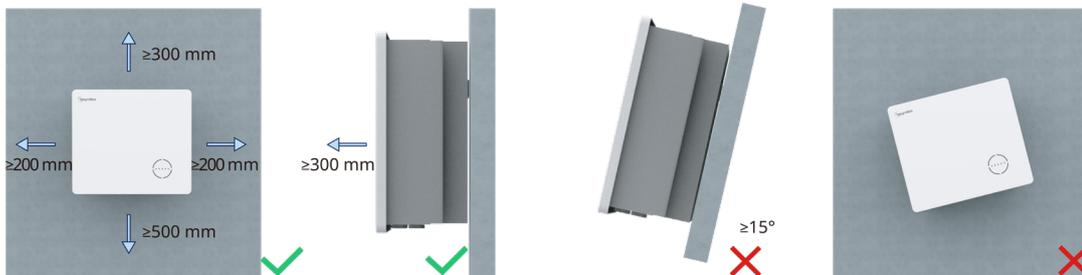
4. El inversor debe instalarse en un entorno con buenas condiciones de ventilación y disipación del calor.
