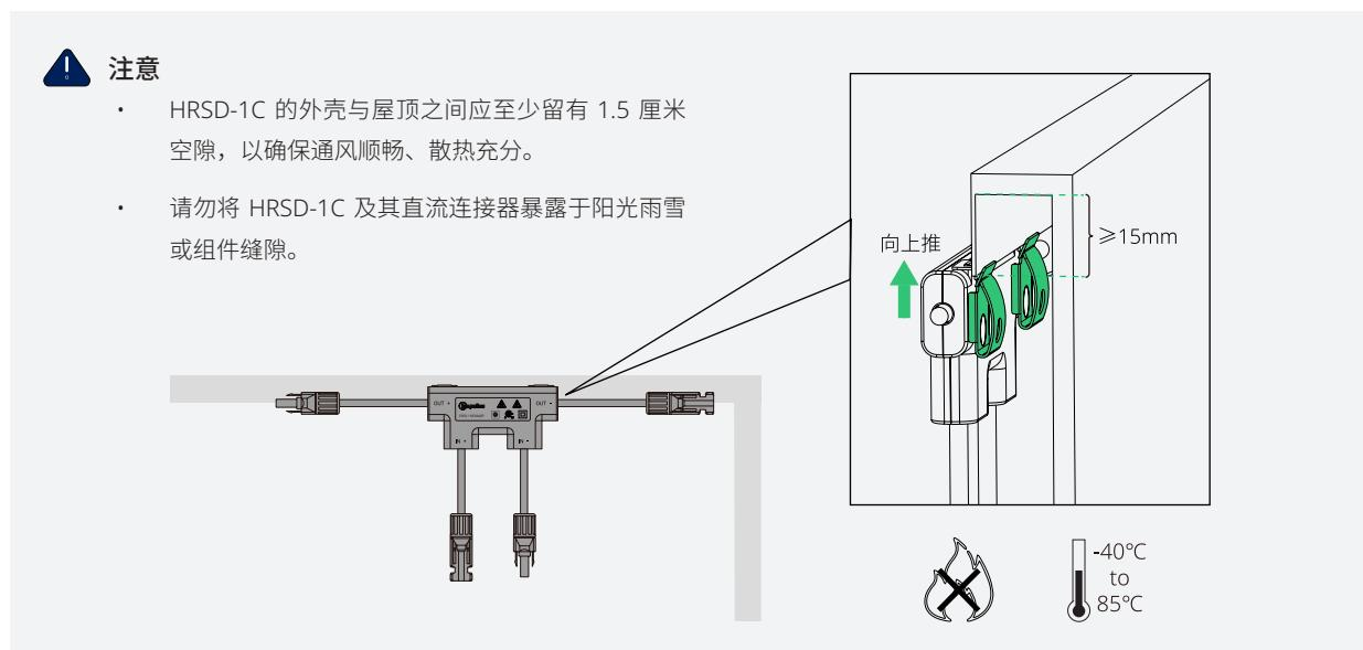
**步骤 2** 将 HRSD-1C 的直流输入端子与光伏组件的直流输出端子对插。“咔哒”声响起证明端子插入到位。
