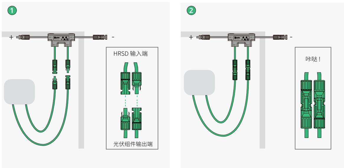
**步骤 3** 将两台相邻 HRSD-1C 的直流输出端子对插。“咔哒”声响起证明端子插入到位。
